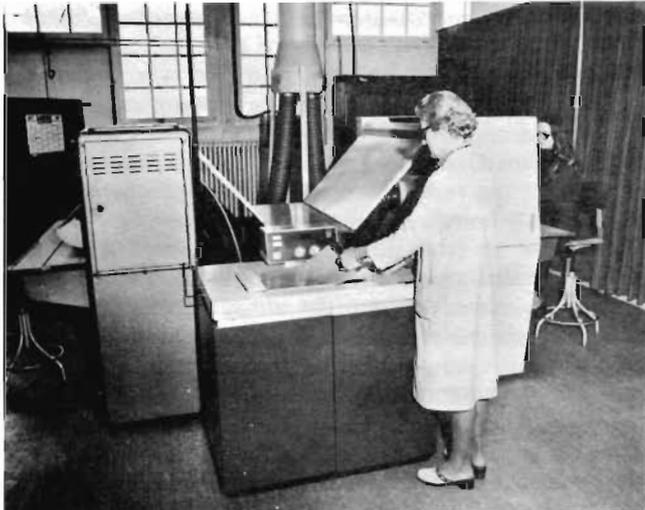
Photocopieur électrostatique automatique, à l'arrière plan deux machines de tirage sur papier diazo.
